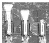
▲ 焊点长度不良
