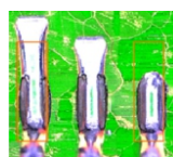
▲ 焊点长度不良
